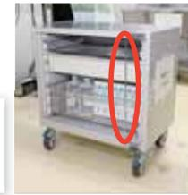
引出しが棚から飛び出さないように、縦に棒を取り付けます。日常的には棒を横にずらして引出しを利用します。キャスター付き什器では移動中の引出し飛び出し防止にも有効です。
