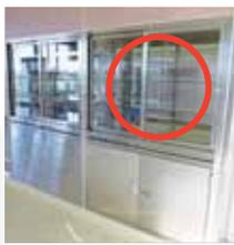
収納棚の内容物がぶつかることで戸のガラスが破損・飛び散る危険性があります。ガラスの破片が飛び散ると二次被害を招く可能性があるため飛散防止フィルムを貼っておくとよいでしょう。
