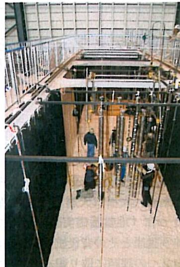
図-4 杭基礎模型の建込み
