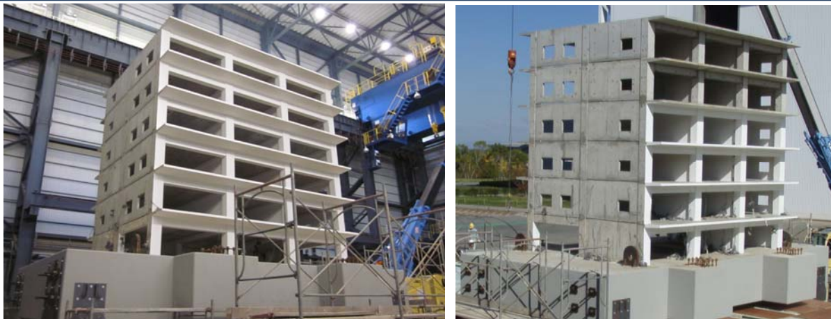
写真1 試験体概要 (鉄筋コンクリート造6層建物・縮尺30%; 平面4.6×5.4m, 高さ6.5m, 重量約320 t)
